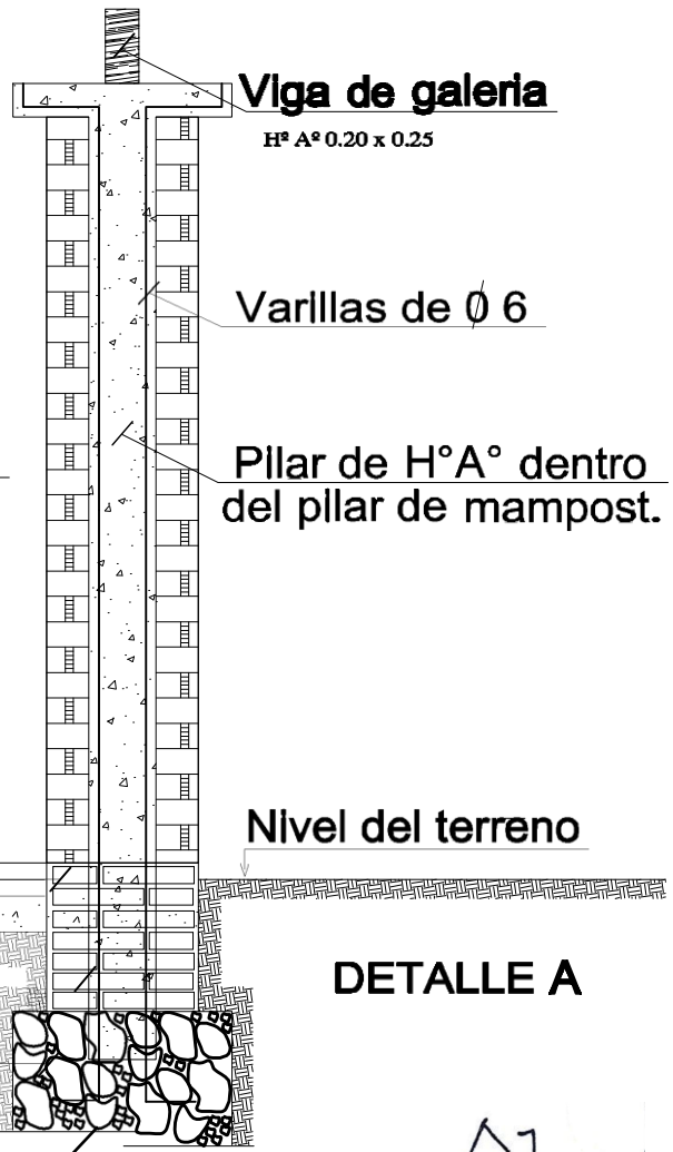
Pilar de mampost. 0.38x0.38 o segun dimensiones del ladrillo local PLANTA
